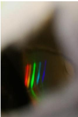
I colori visibili sono solo il rosso, il verde e il blu, ovvero le tre componenti base che permettono l'emissione di luce bianca come effetto complessivo. Di conseguenza, si potrebbe supporre che la lampadina utilizzata fosse un LED.
