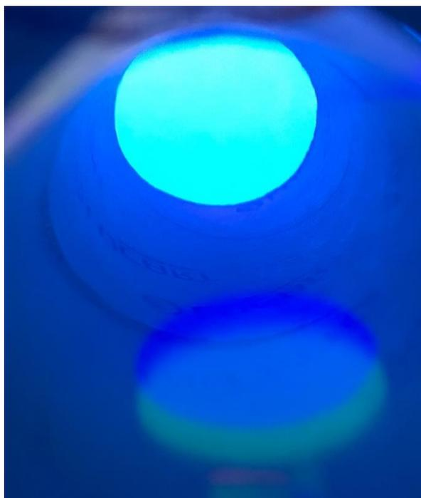
In questo caso notiamo invece una zona verde abbastanza rilevante. Da cosa deriva ciò? La risposta più plausibile è che semplicemente la tonalità del sub-pixel blu non è la stessa del blu puro RGB, perciò per riprodurlo sul display, sia il pixel blu che quello verde si attivano in modo significativo.
